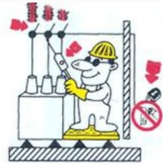
3. Verificar la ausencia de tensión.
