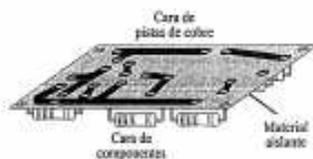
Figura 8.26. Partes de un circuito impreso.
