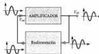
Figura 14.4. Diagrama de bloques de un oscilador RC.
