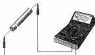
Figura 7.34. Comprobación de un diodo mediante polímetro analógico.
