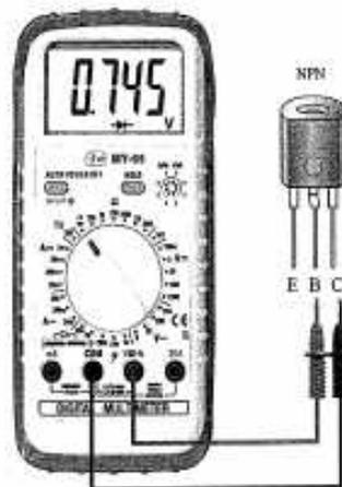
Figura 9.47. Polarización base colector.
