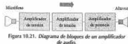
Figura 10.21. Diagrama de bloques de un amplificador de audio.
