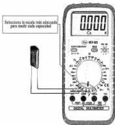
Figura 6.38. Medida de capacidad de condensadores.
