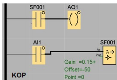
FIGURA 1.47. Diagrama KOP del programa de l'exemple d'utilització del comparador analògic
