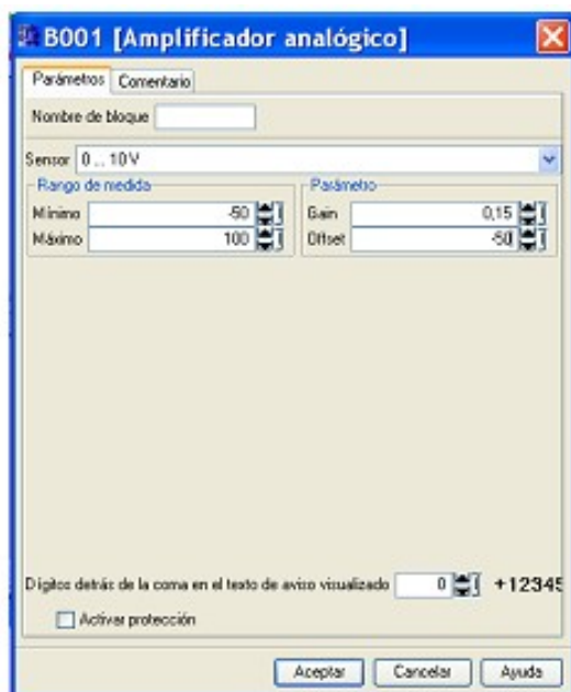
FIGURA 1.46. Finestra amb la configuració de l'exemple d'amplificador analògic
