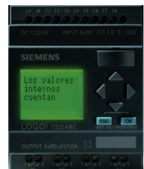
El PLC LOGO! és el PLC més petit de Siemens, molt adequat per a tasques domòtiques.
