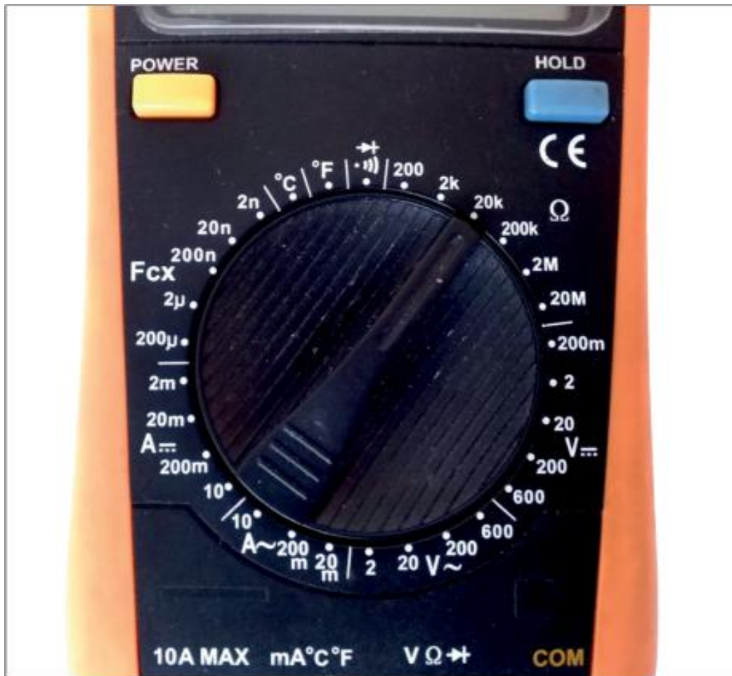
Figura 2.10 – Seleccionen el flujo adecuado y, en el caso de que no se conozca la resistencia, empiecen por el más alto y vayan bajando.
