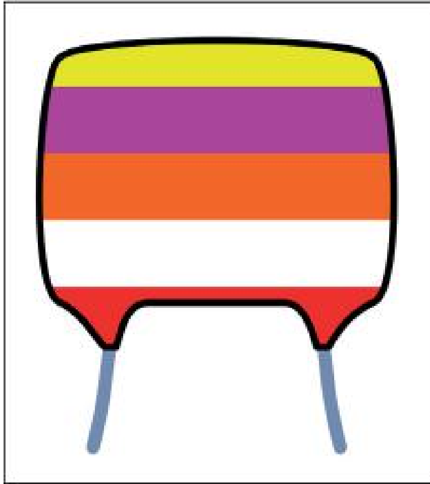
Figura 2.46 – Condensador de película de 47 nF con una tolerancia del 10 % y tensión igual a 250 V.
