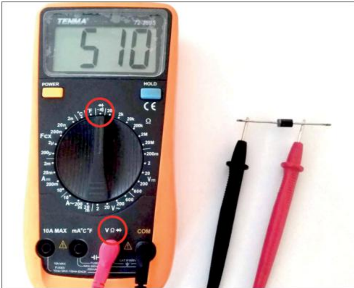
Figura 3.13 – Comprobación de un diodo con un multímetro con función Prueba de diodos. En la pantalla leemos el valor en milivoltios de la tensión detectada en la unión PN.
