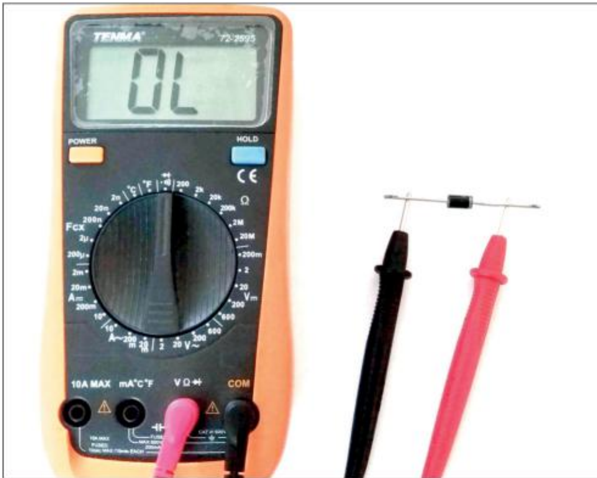
Figura 3.14 – Comprobación de un diodo: al invertir las sondas, se debería detectar un circuito abierto.
