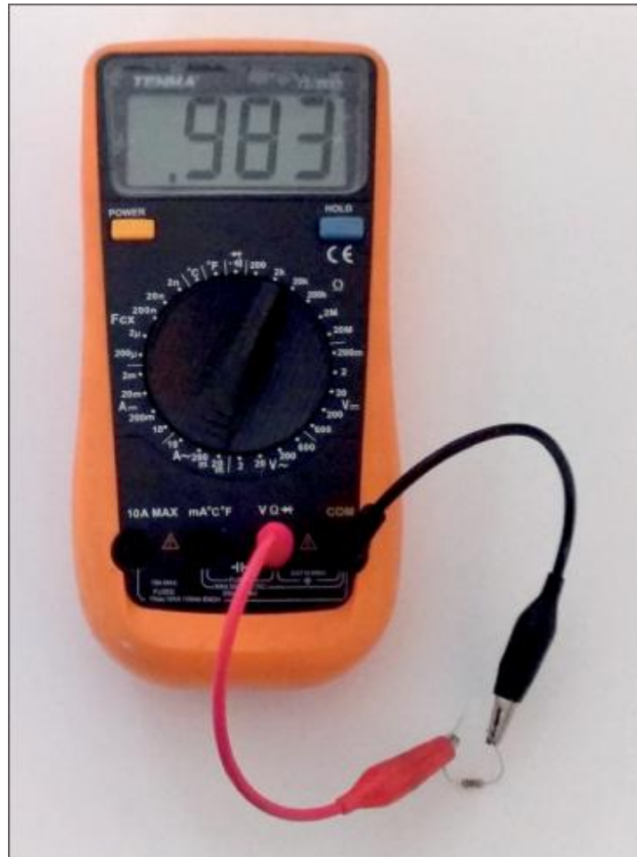
Figura 2.11 – Toquen con las puntas el componente que se desea medir. En esta foto, para tener un contacto más estable, he utilizado pinzas de cocodrilo.
