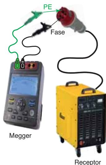
↑ Figura 12.6. Medida de aislamiento de un receptor.
