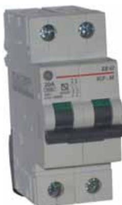
↑ **Figura 4.5.** Interruptor de Control de Potencia (ICP) bipolar de 20 A, siendo la potencia contratada en la instalación donde se ubique este ICP de  $20 \cdot 230 = 4.600$  W.
