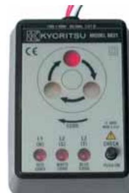
↑ Figura 12.12. Medidor de secuencia de fases (FLUKE) e indicador de sentido de fases (KYORITSU).
