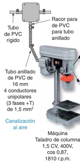
↑ Figura 6.19. Ejemplo de canalización al aire con tubo anillado en montaje «al aire», para alimentar una máquina.
