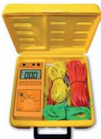
↑ Figura 3.3. Telurómetro.
