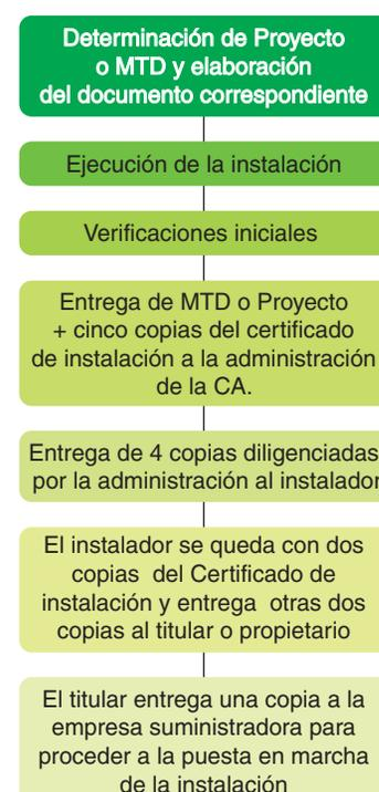
↑ **Figura 3.6.** Proceso de ejecución verificación, tramitación y puesta en marcha de una instalación.
