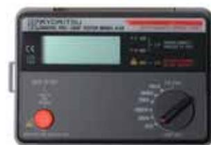
↑ Figura 12.11. Medidor de bucle (KYORITSU).
