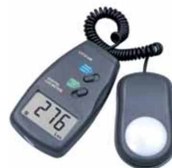
↑ Figura 9.38. Luxómetro. Este dispositivo convierte la energía luminosa en una señal eléctrica que, posteriormente, se amplifica y permite una fácil lectura en una escala calibrada de lux.
