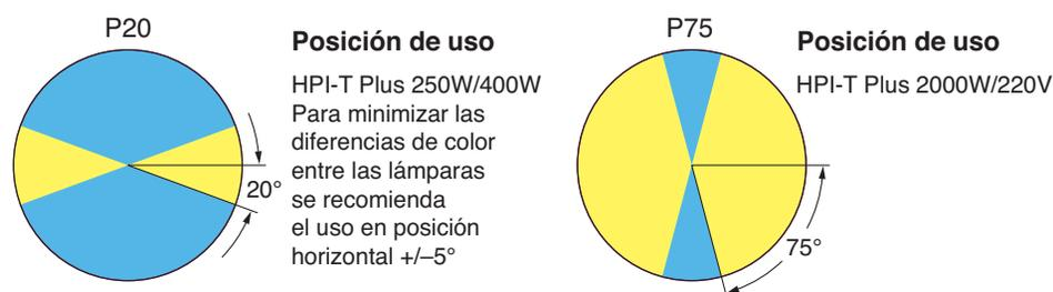
↑ **Figura 9.5.** Posición de funcionamiento en dos tipos diferentes de lámparas descarga de alta intensidad.
