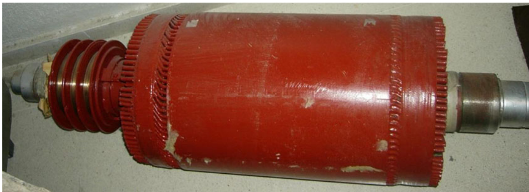
Fig. 28: Rotor bobinado o con anillos
