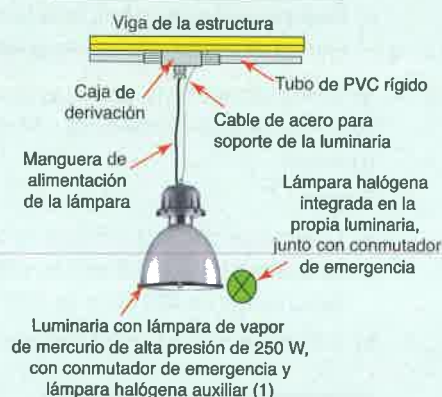
Detalle de canalización y sujeción de las luminarias a instalar en el taller
