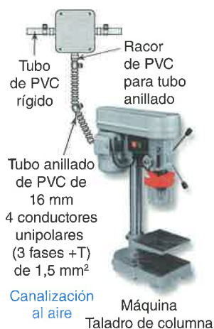
Figura 6.17. Ejemplo de canalización al aire.
