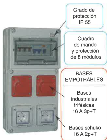
Figura 6.51. Cuadro de distribución de 8 módulos con troquelado con inserción de dos bases industriales trifásicas industriales 16 A 3p+T y dos bases monofásicas schuko 2p+T.
