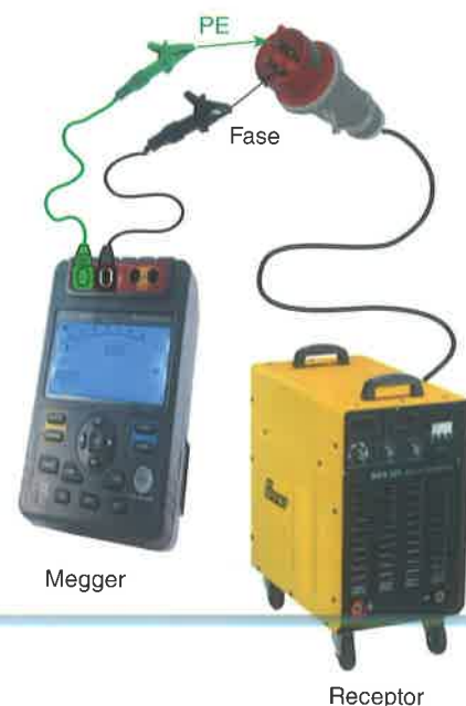
Figura 12.5. Medida de aislamiento de un receptor.
