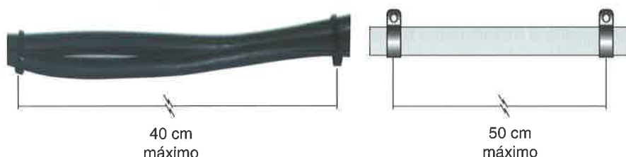
Figura 6.41. Fijación de cables sobre paredes.
