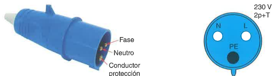
Figura 10.16. Clavija industrial de 230 V 2p+T.
