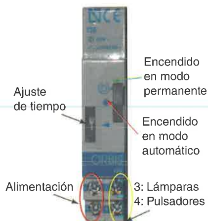
Figura 2.3. Automático de escalera para carril DIN (ORBIS).
