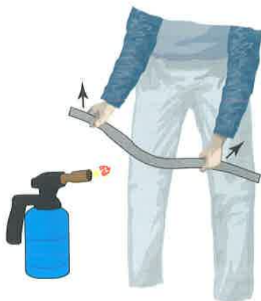
Figura 6.11. Proceso de doblado, mediante soplete, de tubo de PVC rígido.
