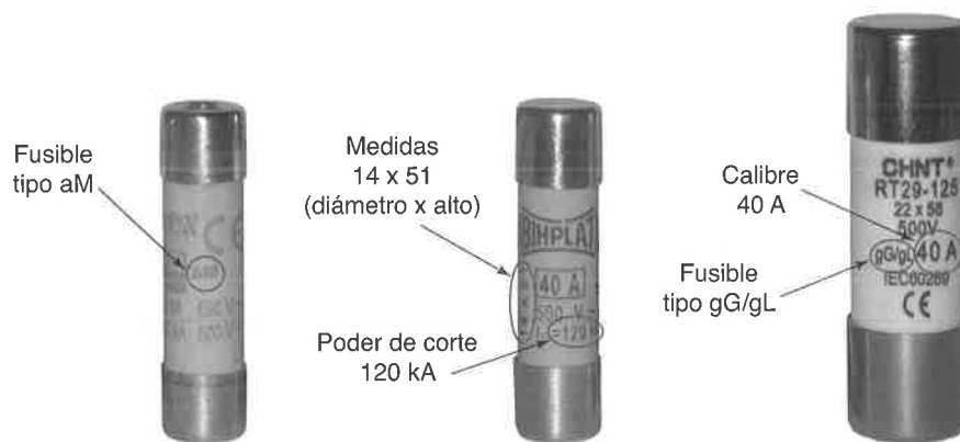
Figura 7.5. Características de los fusibles.
