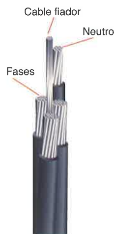
Figura 5.8. Cuatro conductores trenzados para redes aéreas tipo RZ 06/1 kV Al con cable fiador.
