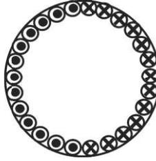
Si se supone una distribución uniforme de conductores en todo el paso polar, y un número de conductores muy elevado, la forma de la onda de fuerza magnetomotriz es triangular:
