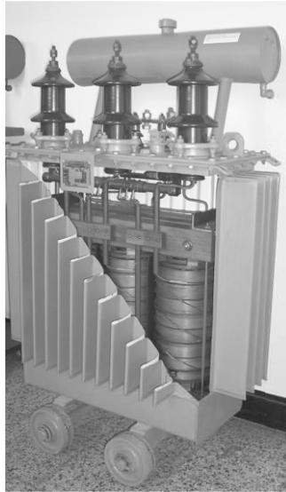
*Figura 3.7. Sección de un transformador en baño en aceite.*
